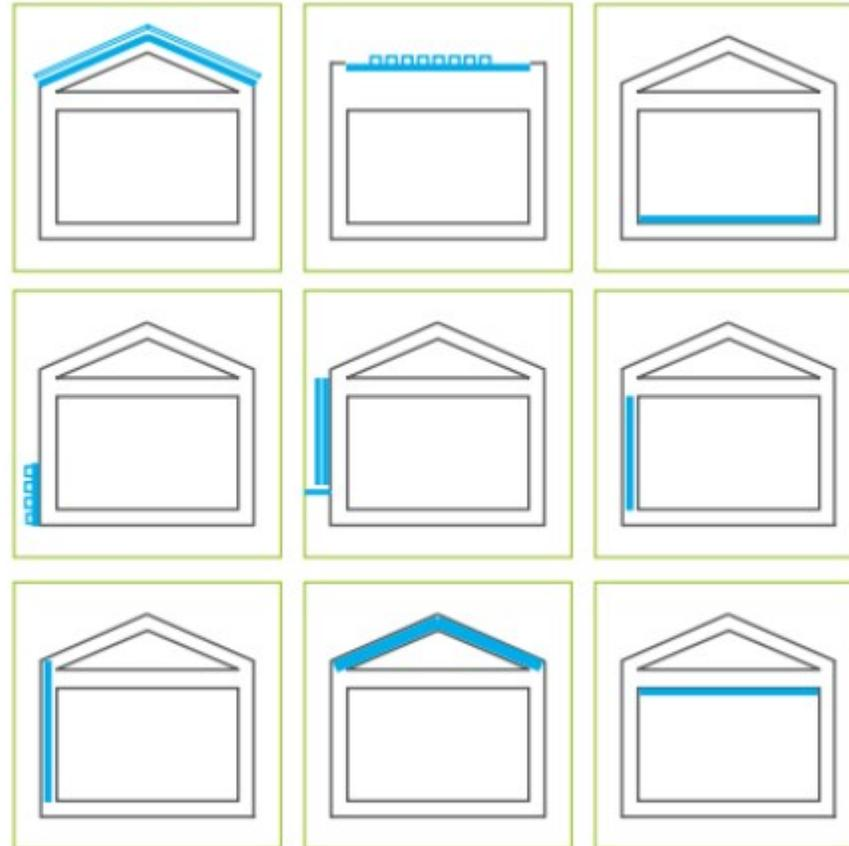
**DAD:** Außendämmung von Dach oder Decke, vor Bewitterung geschützt, Dämmung unter Deckungen
