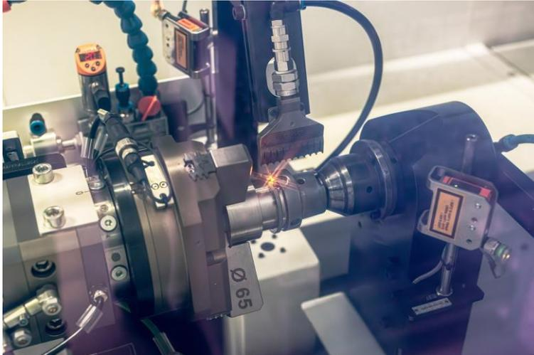
*HSK-Aufnahmen werden mit einer neu entwickelten Laserhärteanlage bearbeitet. Die Anlage ersetzt das umweltbelastende Salzbadhärten und benötigt deutlich weniger Energie.*
